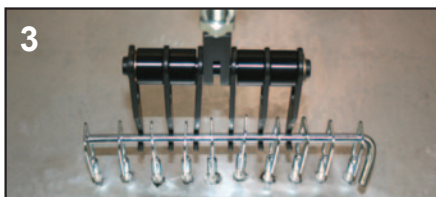
Aluminum Stud Dent Pulling
